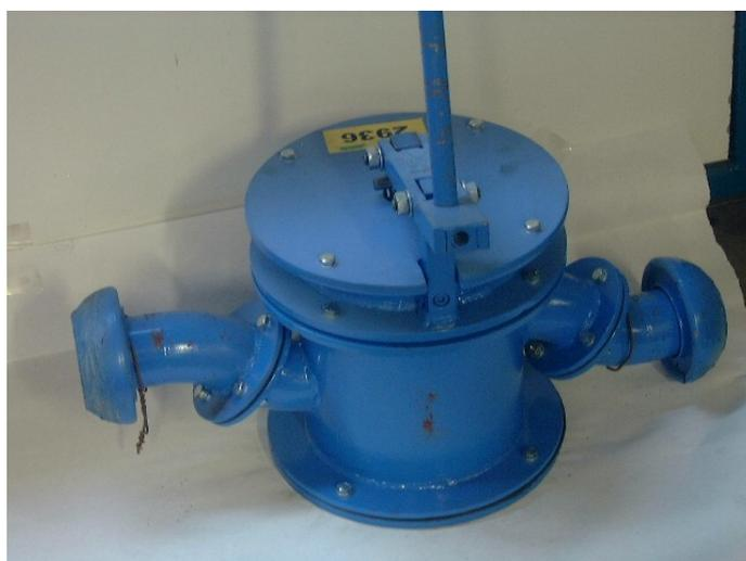
La pompe présentée ici a une capacité de 1.5 litres par coup, soit une capacité théorique d'environ 100 litres/min. Elle pèse une quarantaine de kg.
