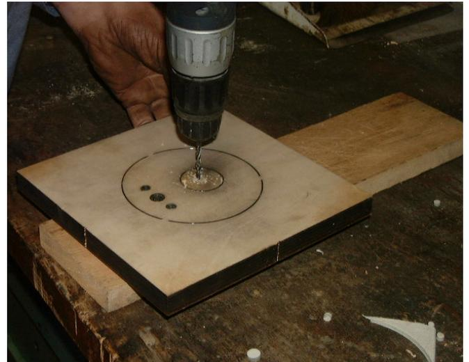
si nécessaire, forage d'un trou de dégagement
