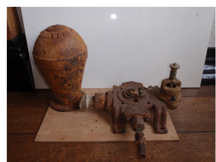
Bélier Hydraulique produit à Anvers dans les ateliers W. Garvens installé à Envoz, Belgique
