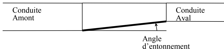
Figure 48 : Entonnement dans un déversoir
