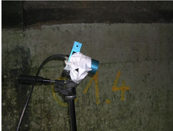
Figure 104 : Caméra de surveillance montée pour les essais sur trépied de photographe
