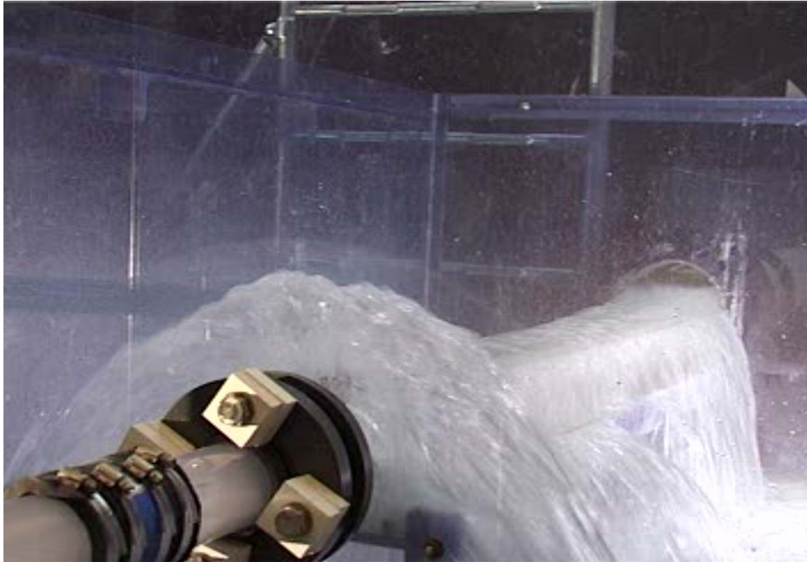
Figure 7 : Photographie d'un ouvrage à seuil haut avec conduite aval en charge.
