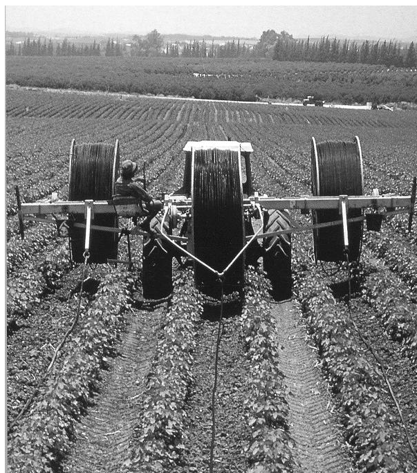
Fig. 105. Déploiement mécanique des conduites latérales Tiré de la brochure "Naan"
