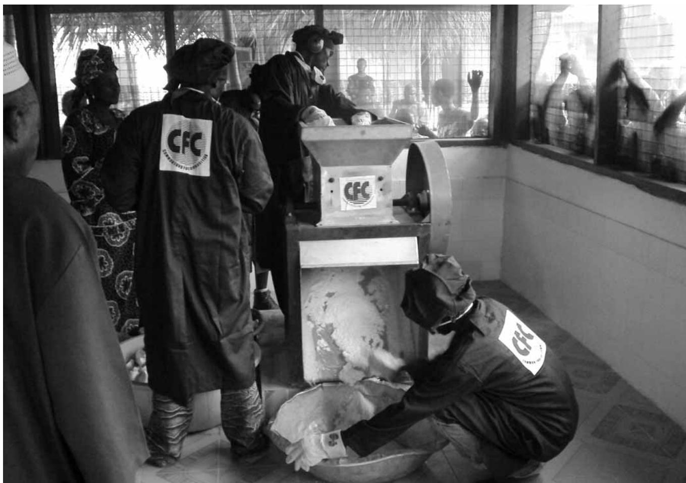
Une machine motorisée pour râper le manioc commandée par IITA/CFC en Sierra Leone.
