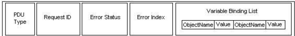
FIG. 3 – PDU SNMP (requêtes et réponses).
