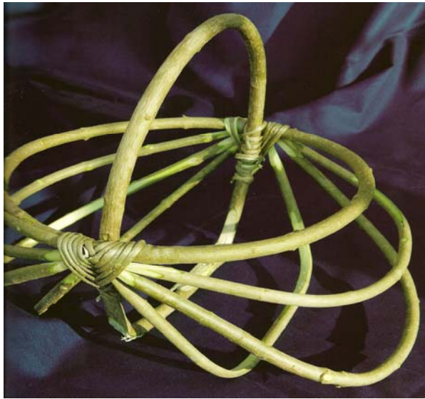
Armature réalisée et tissage commencé.
