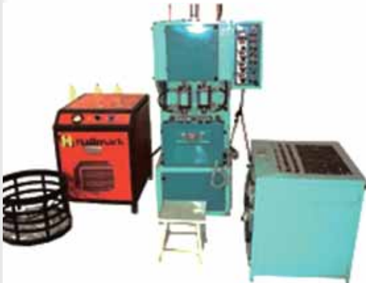
Machine de fabrication de bouteilles en plastique Source : CDT
