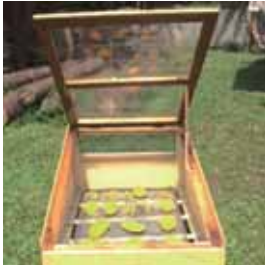
Séchage de pulpe de mangue dans séchoir NRI
