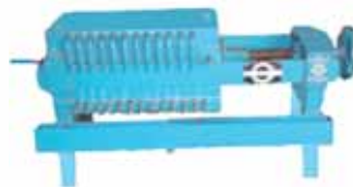
Appareil de filtration / remplissage des emballages (Source : CDT)
