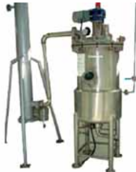
Evaporateur muni d'un agitateur (utilisé pour la fabrication des confitures)
