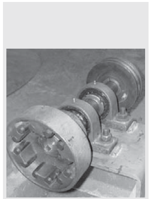
Figure 33 : Accouplement si le moteur utilisé n'a qu'une faible résistance radiale
