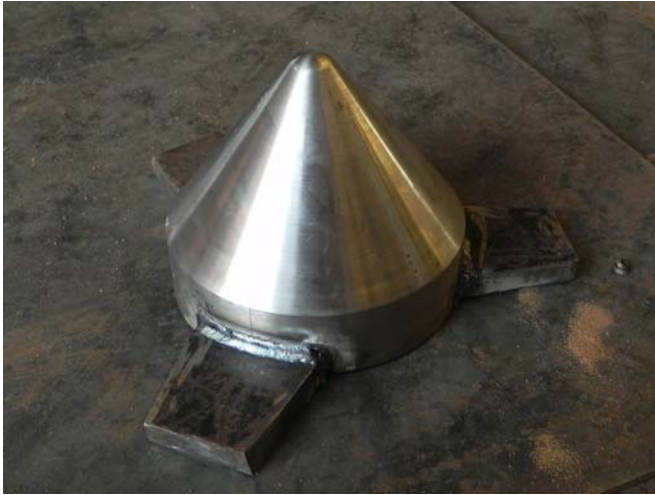
Soudure des 3 oreilles du cône de pression à 120° avant perçages des trous de passage colonnes sur fraiseuse
