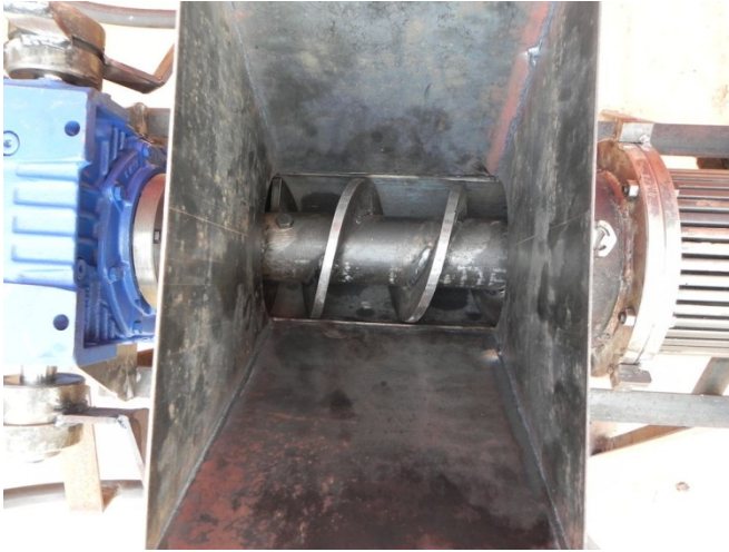
Détail trémie et vis d'archimède
