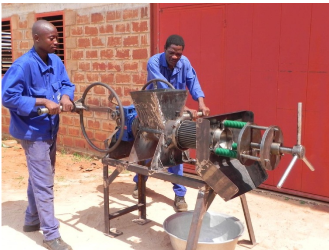
Formation d'artisans pour la fabrication d'une presse BP manuelle pour huile de palme 2010
