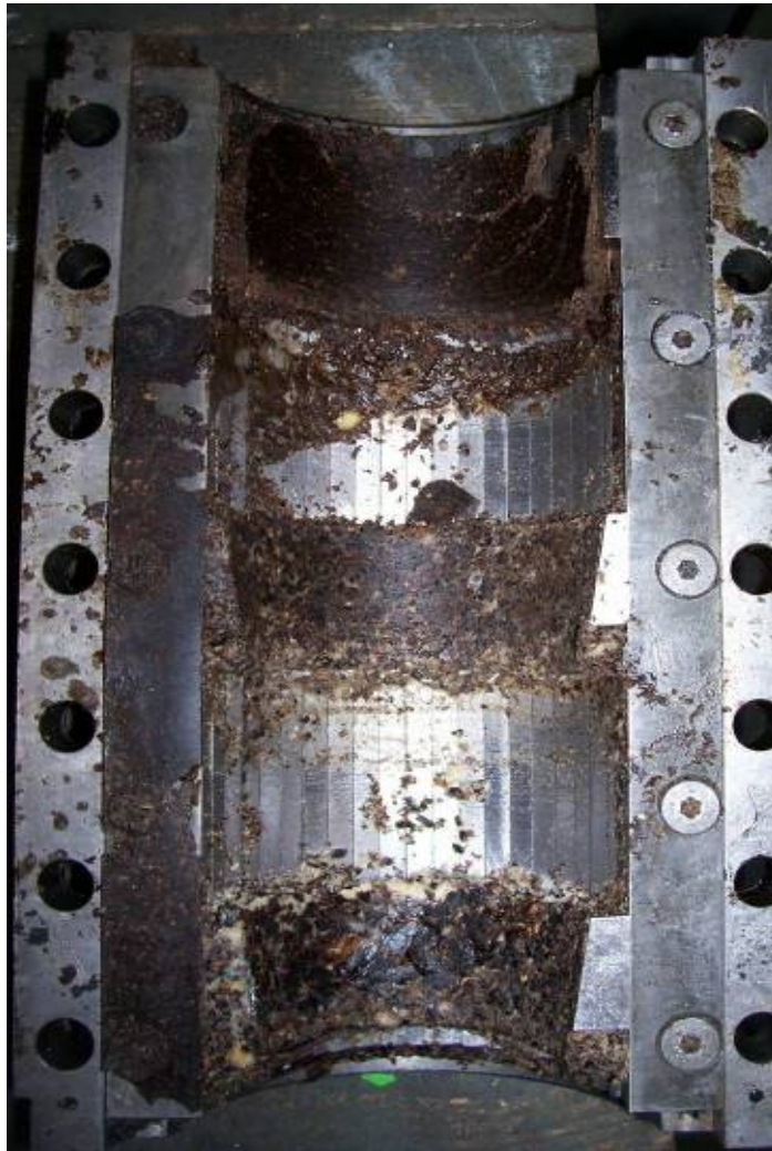
Photo 1 : Cage démontée après les essais 1 et 2
