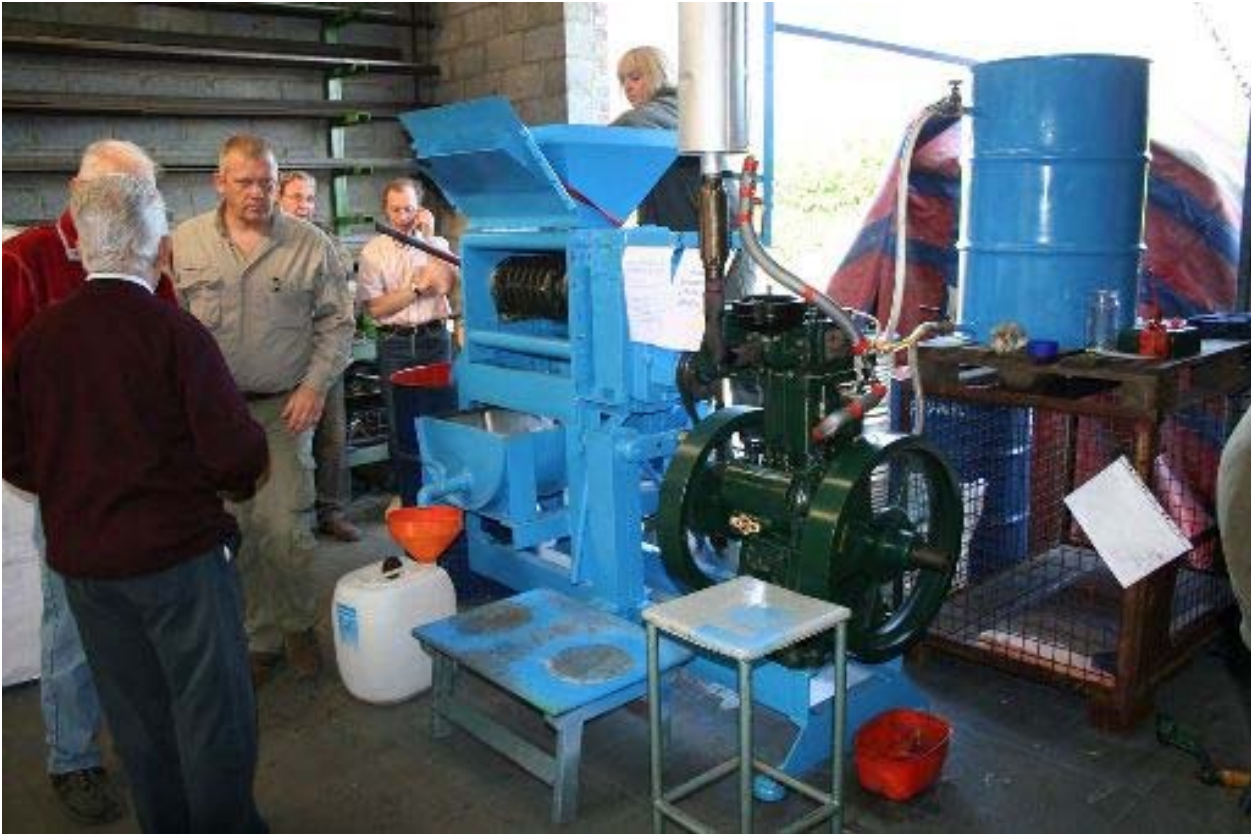
Photos de la presse à jatropha en fonctionnement lors de la fête CODEART le 28 septembre 2008. Le moteur de type LISTER 8/1 (6kW, 8 ch) est alimenté en huile de jatropha.
