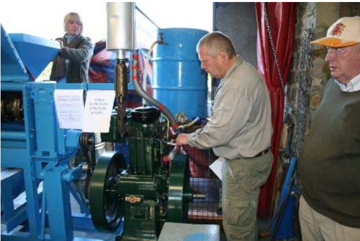
Photos de la presse à jatropha en fonctionnement lors de la fête CODEART le 28 septembre 2008. Le moteur de type LISTER 8/1 (6kW, 8 ch) est alimenté en huile de jatropha.
