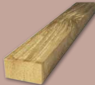
Lambourdes rabotées (lisse), arêtes arrondies - Bottelées par 6 Essences : Piquia ou Angelim, naturellement durable classe IV - Section : 38 x 72 mm
