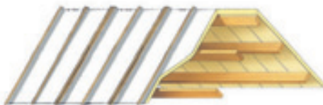
Pose des caissons
