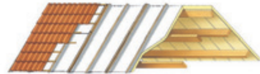
Pose de la couverture
