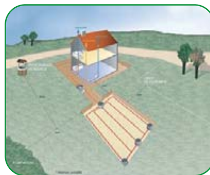
Filtre à sable non drainé
