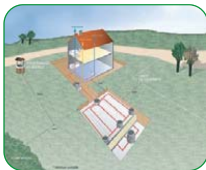
Filtre à sable drainé
