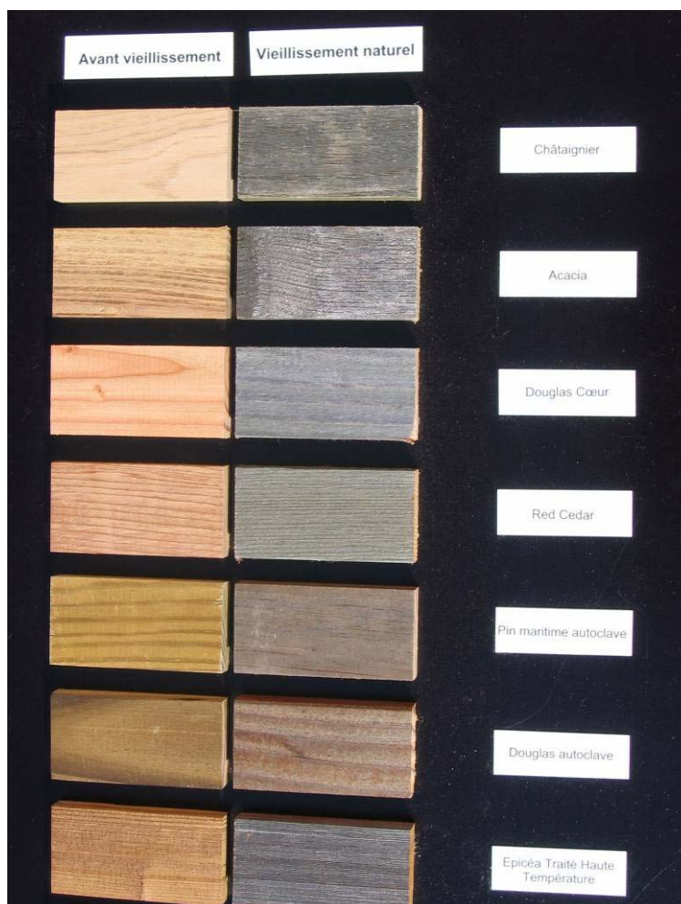
Figure 4 : Outil de sensibilisation sur le vieillissement des bois pour la partie sans finition
