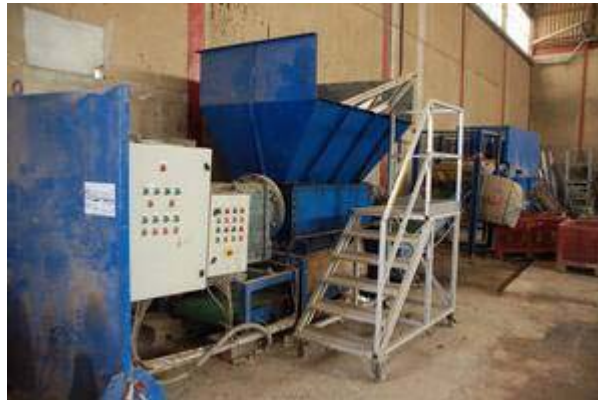
Figure 21 : Broyeur de menuiseries de la société Lévy (source : http://www.dna.fr/ )
