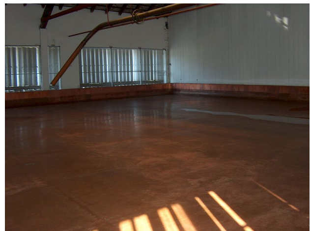
Cuve ouverte, large et peu profonde, pour le refroidissement et du lambic et son ensemencement par les levures ambiantes après la cuisson
