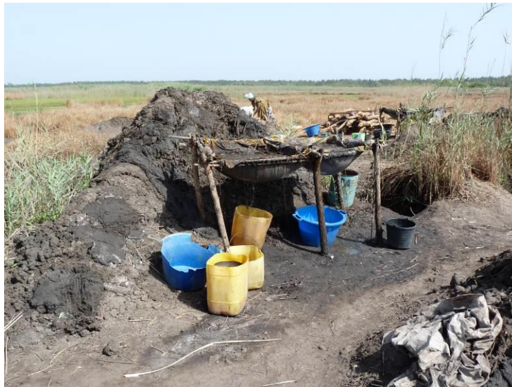
Unité de filtration composée de deux filtres et destinée à un ou deux bacs de cuisson
