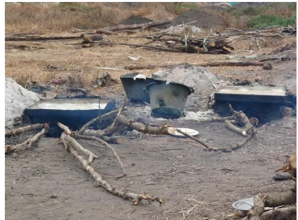
Unité de filtration composée de deux filtres et destinée à un ou deux bacs de cuisson
