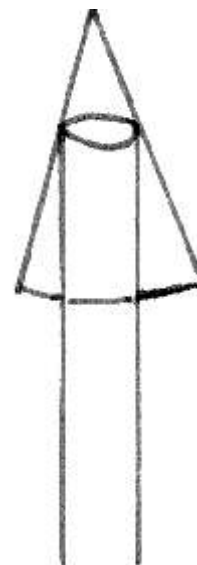
Elimer les barbes aussi sur le bord extérieur, le papier verre en cône, face qui gratte vers l'intérieur.
