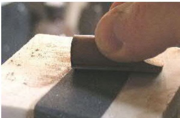
utilisation d'une bande de papier abrasif
