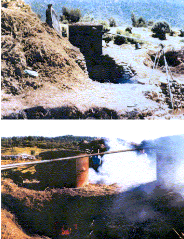
Figure 19. Exemples de montages erronés qu'on peut rencontrer chez certains professionnels au Maroc (Photos B. Benjilali).
