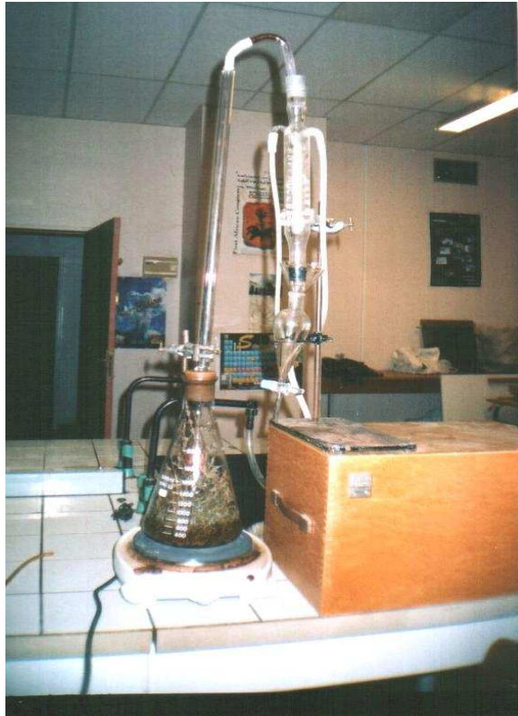
Fig. 17: Montage d'hydrodistillation employé pour l'extraction de l'huile essentielle.
