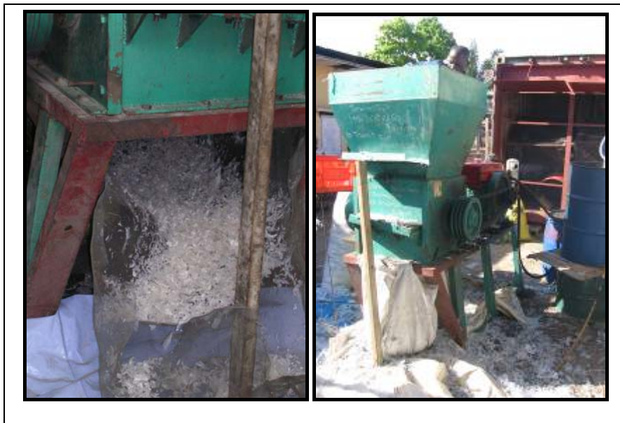
Photos 1 et 2: Déchiquetage avec un broyeur (équipé d'un moteur diesel)
