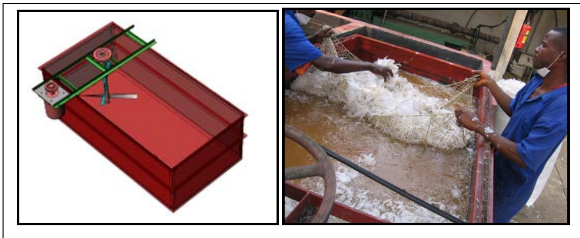
Figure 1 et Photo 3 : Cuve de lavage et manipulation des plastiques avec un filet de pêche
