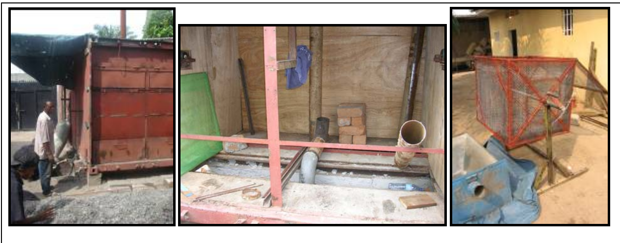
Photos 6, 7 et 8 : Four de séchage, avec tiroir pour retirer les plastiques et modèle de « roulette de loto »
