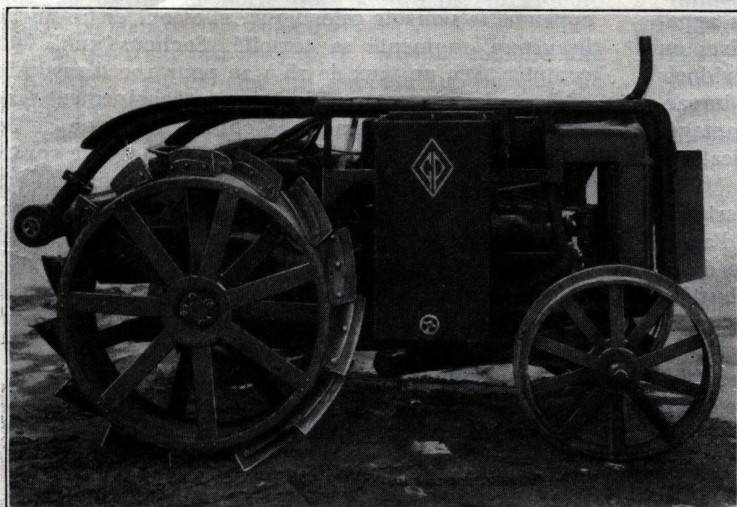
Fig. 21. — Tracteur agricole, vue côté épurateur.
