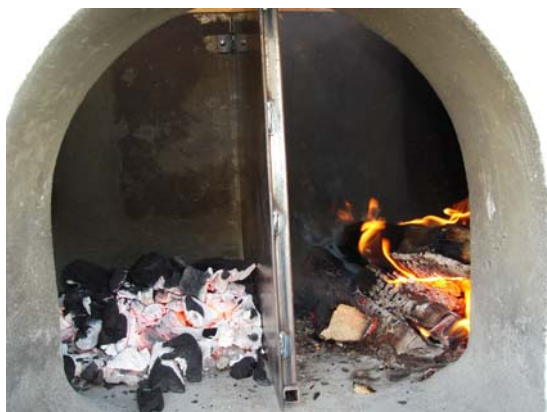
Photo 3 : création de deux chambres de fumage sur le fumoir Chorkor
