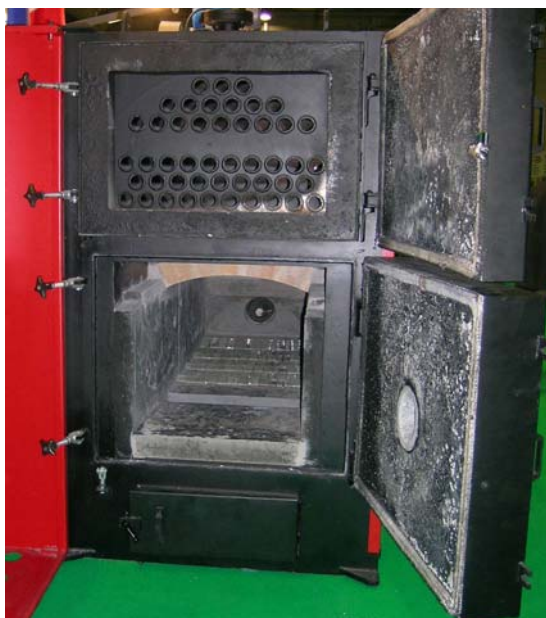
Figure 22 : Chaudière à plaquette de bois Le foyer à grille mobile est visible en bas et l'échangeur à tubes de fumées dans la partie supérieure
