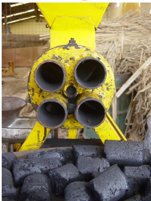
Briquettes de Biocharbon en sortie de la Rotor Press
