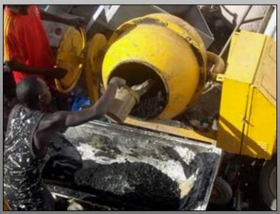
2. Nouveau système de production « motorisé » (bétonnière et Rotor Press électriques)
