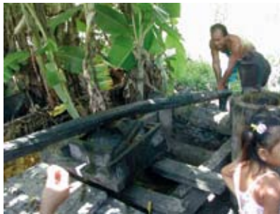
Photo 3 : Presse manuelle à huile de palme. Amazonie (Photo Cirad)
