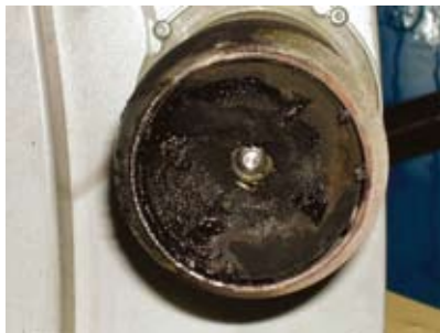
Photo 10 : Déflecteur d'air après 4 jours à 50/50, tournesol/fioul (à droite : après nettoyage) (Photo Cirad)
