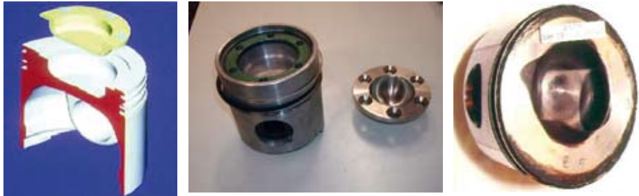
Photo 7 : a) Conception CAO des modifications. b) Exemple de réalisation. c) Piston modifié après 500 heures à huile de colza (Photo Cirad)
