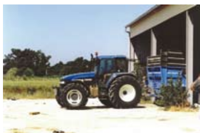
Photo 8 : Tracteurs avec moteur à injection direct modifié. Huile de tournesol, France, 2001 (Photo Cirad)
