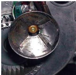
Photo 10 : Déflecteur d'air après 4 jours à 50/50, tournesol/fioul (à droite : après nettoyage) (Photo Cirad)
