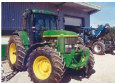
Photo 8 : Tracteurs avec moteur à injection direct modifié. Huile de tournesol, France, 2001 (Photo Cirad)
