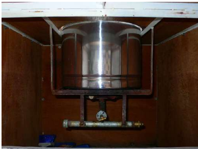
La partie de la casserole sous la table, avant son isolation par de la laine de verre.
