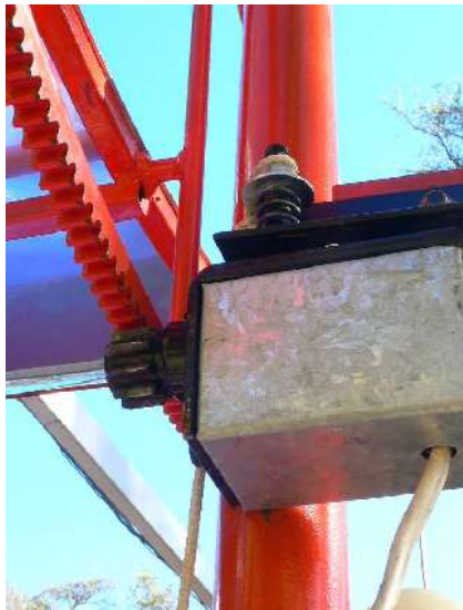
Le 'suivi' du réflecteur (appareil à compenser le mouvement du soleil).
