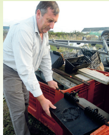
Tony Legg, de Jersey Seafarm, a conçu le panier Ortac pour les huîtres. Une trappe a été intégrée pour nourrir les ormeaux.
