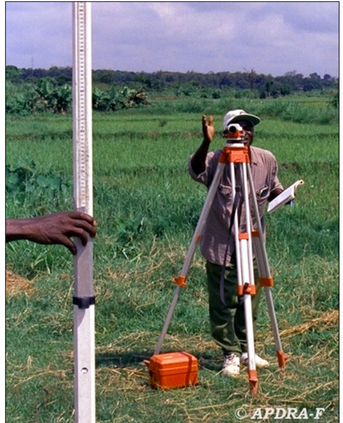
Photo 20 : aménagiste réalisant un piquetage dans un bas-fond (Côte d'Ivoire).
