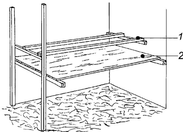
Figure 17 : Perchoir (1) avec planche à excréments (2)
