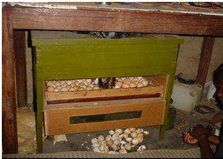
Figure 8 : Modèle de couveuse à pétrole
