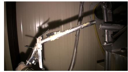
Embuc utilisé pour le gavage pneumatique industriel des canards
