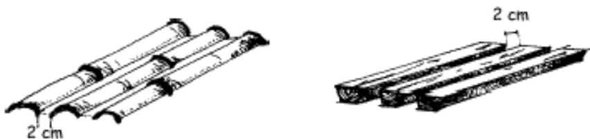
Figure 16 : Deux types de sols à claire-voie : en bambou et en poutres en bois
