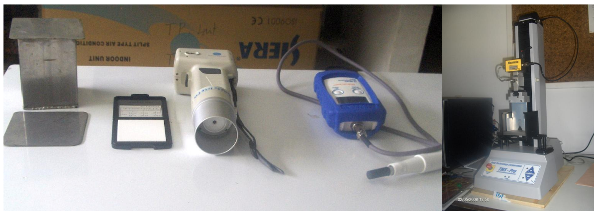
Photographie 10 : Appareils utilisés pour les analyses instrumentales (de gauche à droite : PRE, Couleur, pH, Tendreté).
