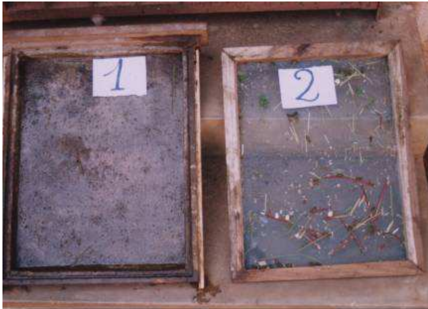
Figure 29 : Constituant du tiroir (1-dispositif de récupération de l'urine, 2- le tamis de séparation des résidus solides de l'urine)
