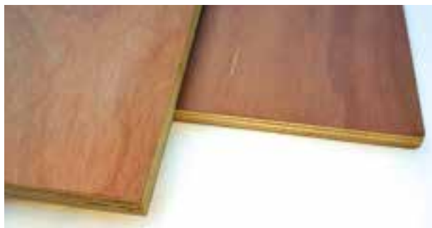
▲ Photo 31 : Face et contreface de contreplaqué © M. Vernay
