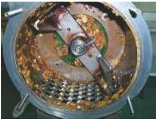
Figure 2 – Broyage des pommes dans un « broyeur à couteaux »
