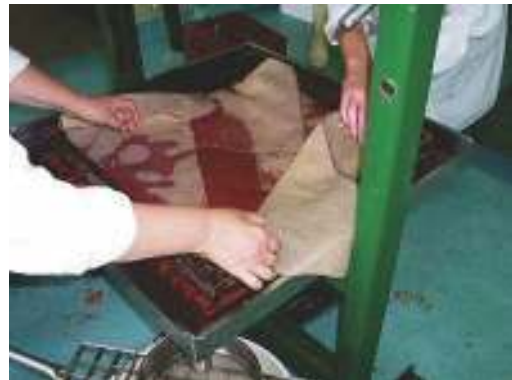
Figure 4 – Toiles de contention des broyats dans la « presse à paquets »
