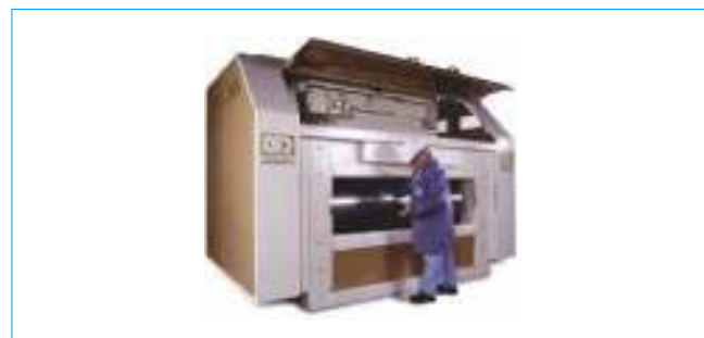
Figure 5 – Aplatisseur à graines oléagineuses (doc. Daman Croes)
