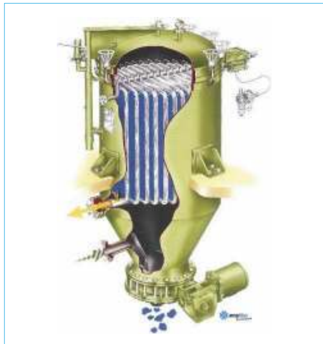
Figure 8 – Filtre à débatissage automatique Niagara (Amafilter)
