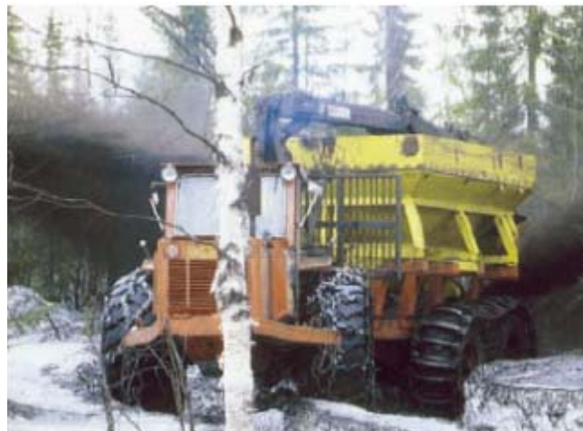
Retour des nutriments à la forêt par l'épandage des cendres générées par les biocombustibles
