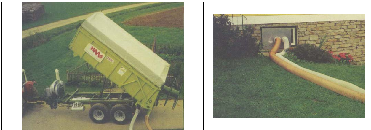
Photos 16 : Transport de la biomasse transformée en biocombustible jusqu'à l'utilisateur final au moyen d'un camion benne (HAAS)
