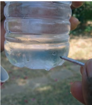
Photo 9-8 : Perforation de la bouteille en plastique
