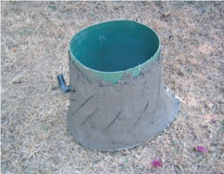
Photo 6-21: Moitié supérieure du seau recouverte de béton
