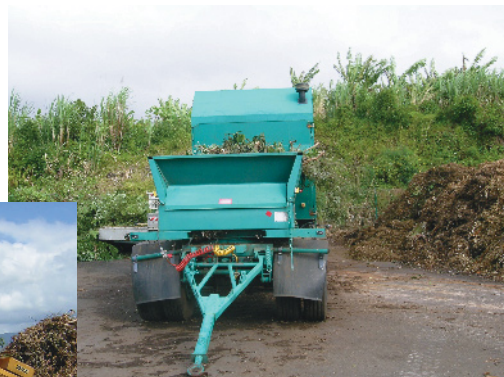
Plate-forme de Saint-Rose pour le compostage de déchets verts urbains + fraction fermentescible des ordures ménagères : broyeur. © V. van de Kerchove
