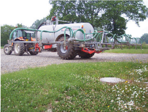
Rampe d'épandage multi-buses. © V. van de Kerchove
