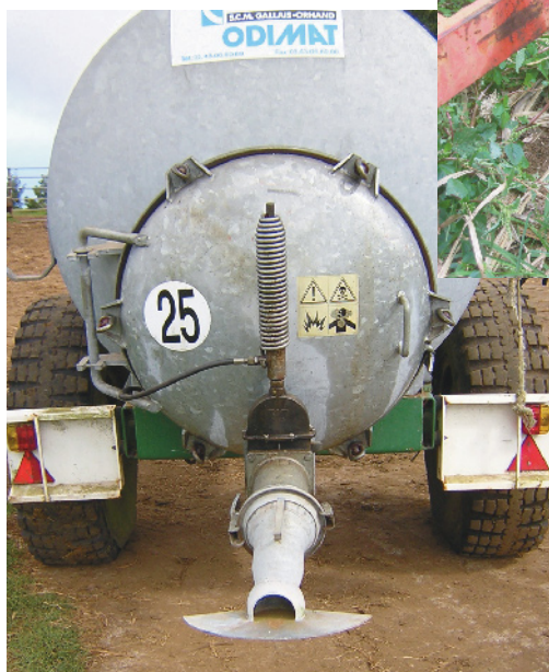
Cuve avec déflecteur. © V. van de Kerchove
