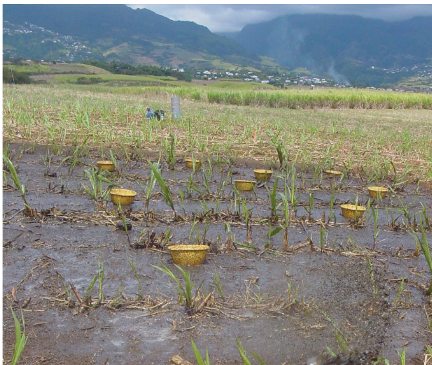
Cuvettes pour mesurer et échantillonner un épandage de lisier au champ. © F. Feder
