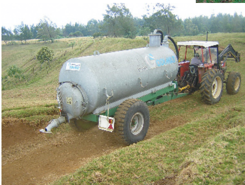
Cuve avec déflecteur. © V. van de Kerchove
