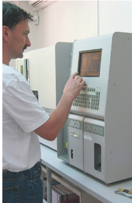
Appareil d'analyse des teneurs en N et C. © V. van de Kerchove
