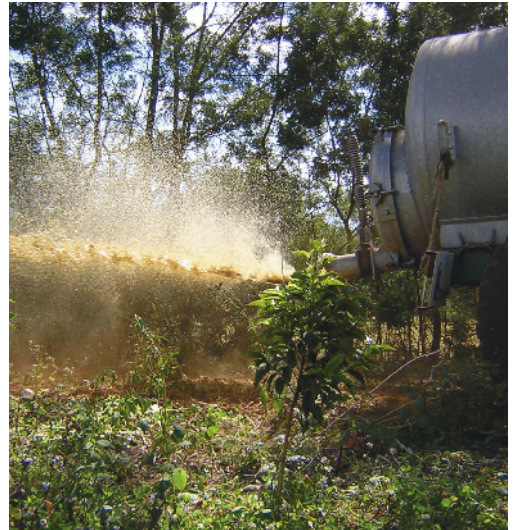
Épandage de lisier avec une cuve à déflecteur entraînant une forte volatilisation de l'ammoniac du lisier. © V. van de Kerchove
