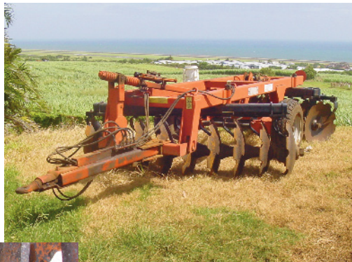
Type de pulvérisateur semi lourd (cover-crop) utilisé en général à La Réunion pour enfouir la matière organique. © P.-F. Chablier
