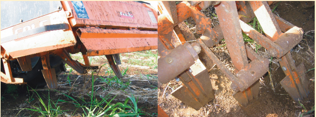
Utilisation de la rotobèche pour enfouir de la matière organique dans une culture de canne à sucre. © V. van de Kerchove
