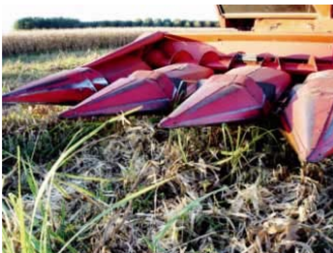
Figura 4. Altura da plataforma na colheita de milho
