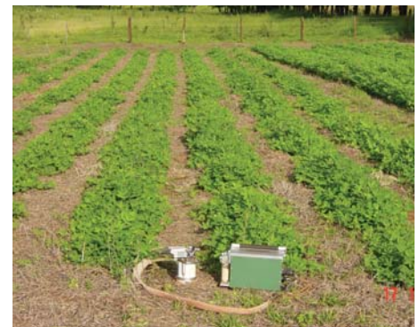
Figura 5. Amendoim no sistema plantio direto sobre pastagem e destaque para equipamento LI-6400 para leitura do fluxo de CO 2 . Apta Centro-Norte, Pindorama, março de 2004
