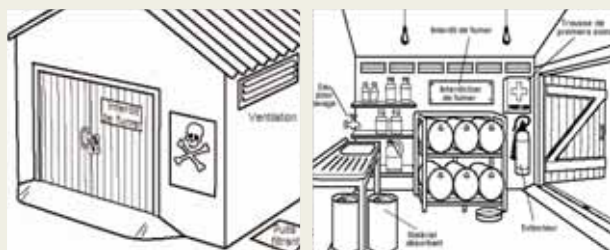
Figures 3 et 4. Grand entrepôt de stockage des pesticides – vues de l'extérieur et de l'intérieur
