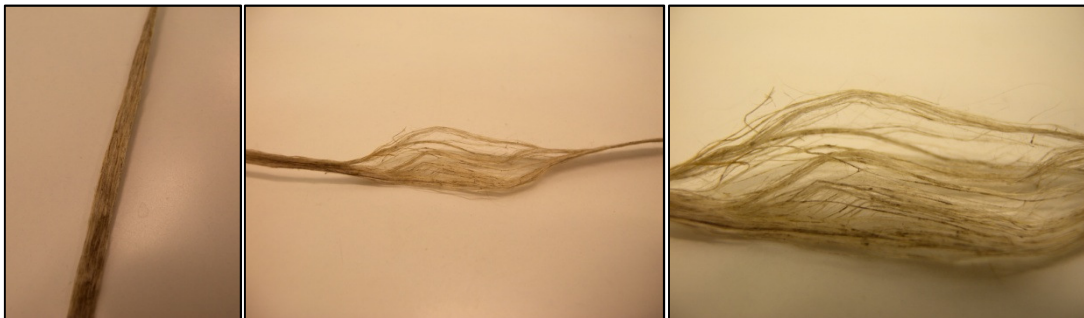
Figure 21 : Mèche de lin et fibres qui la constituent
