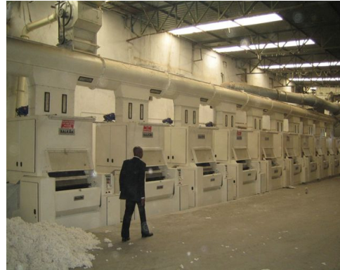
Vue batterie d'égreneuses à rouleaux
