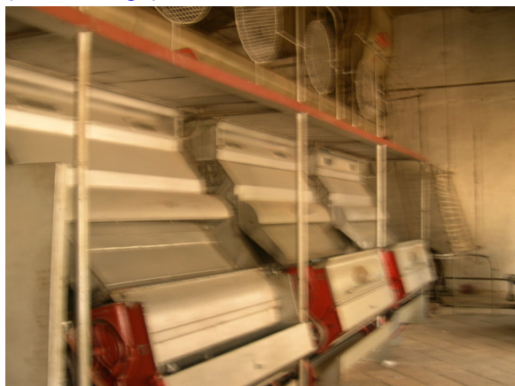
Figure 24 : Les égreneuses de l'usine de COTOLU actuellement en fonction à Dilolo dans le Lualaba (Sud-Katanga).
