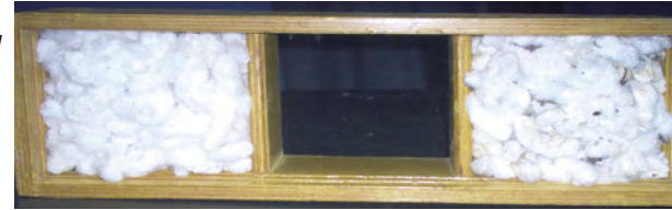
Figure 33. Boîte de standard coton-graine : 1 er choix à gauche, 2 e choix à droite ; la case centrale reçoit l'échantillon à classer. (Cliché A. W. Diawara © CMDT)
