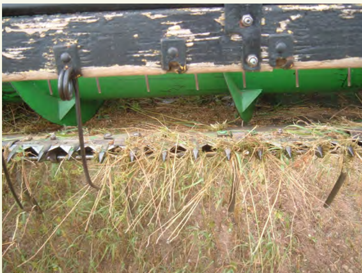
Photo 8 - Couteaux d'une batteuse embourbés de fibres. © Dominic Leblanc (GCACS)
