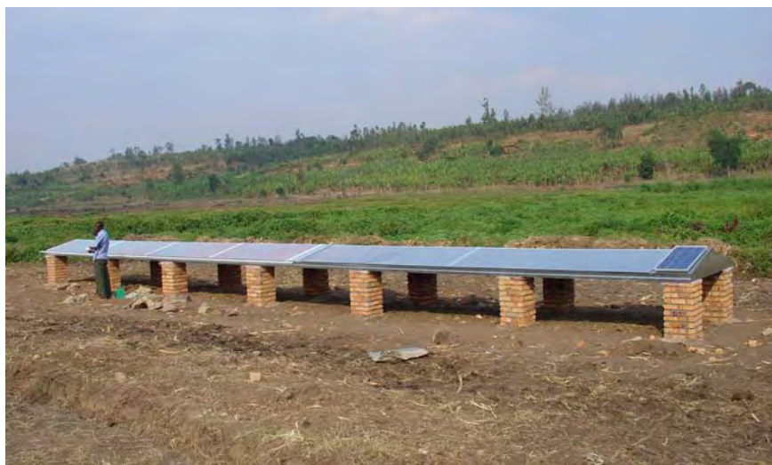
Photo n° 5: séchoir solaire à tunnel "Hohenheim" utilisé pour les petits piments au Rwanda
